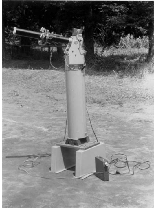
地上で試験中のひまわりカメラ
