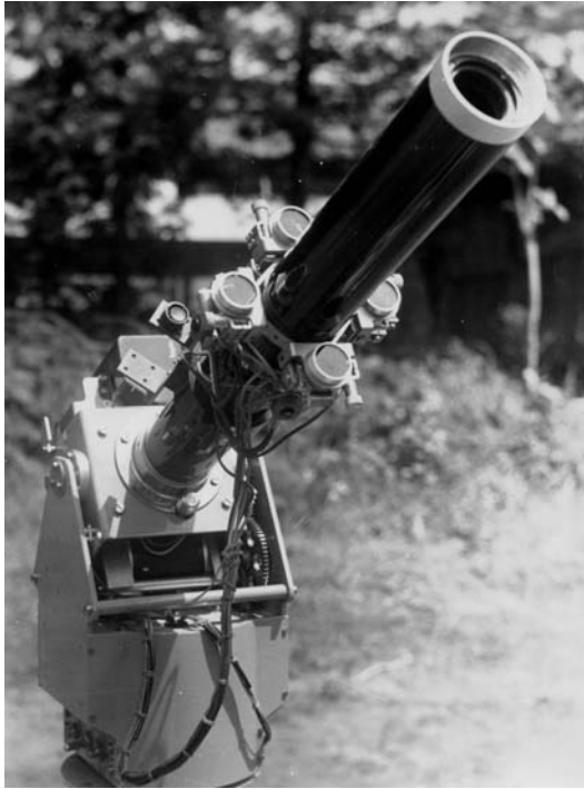
地上で試験中のひまわりカメラ
