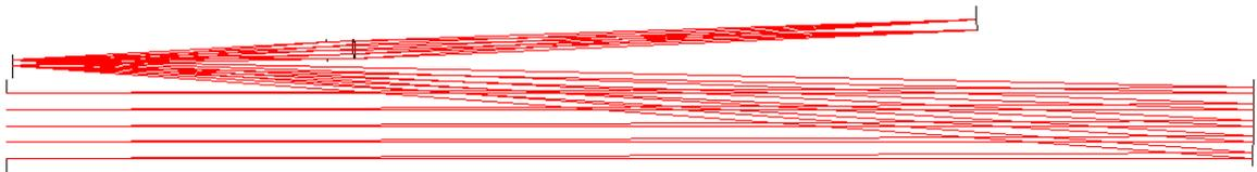
図5.  $h = 110\text{mm}$ の対象型配置。リオストップから50mmのところを $f = 400\text{mm}$ の結像レンズをおいた。
