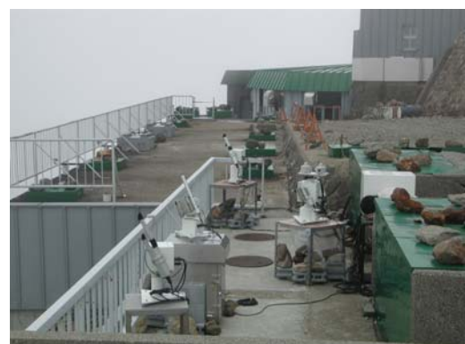
観測所に設置された分光日射計
